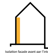
Isolation façade avant par l'intérieur
